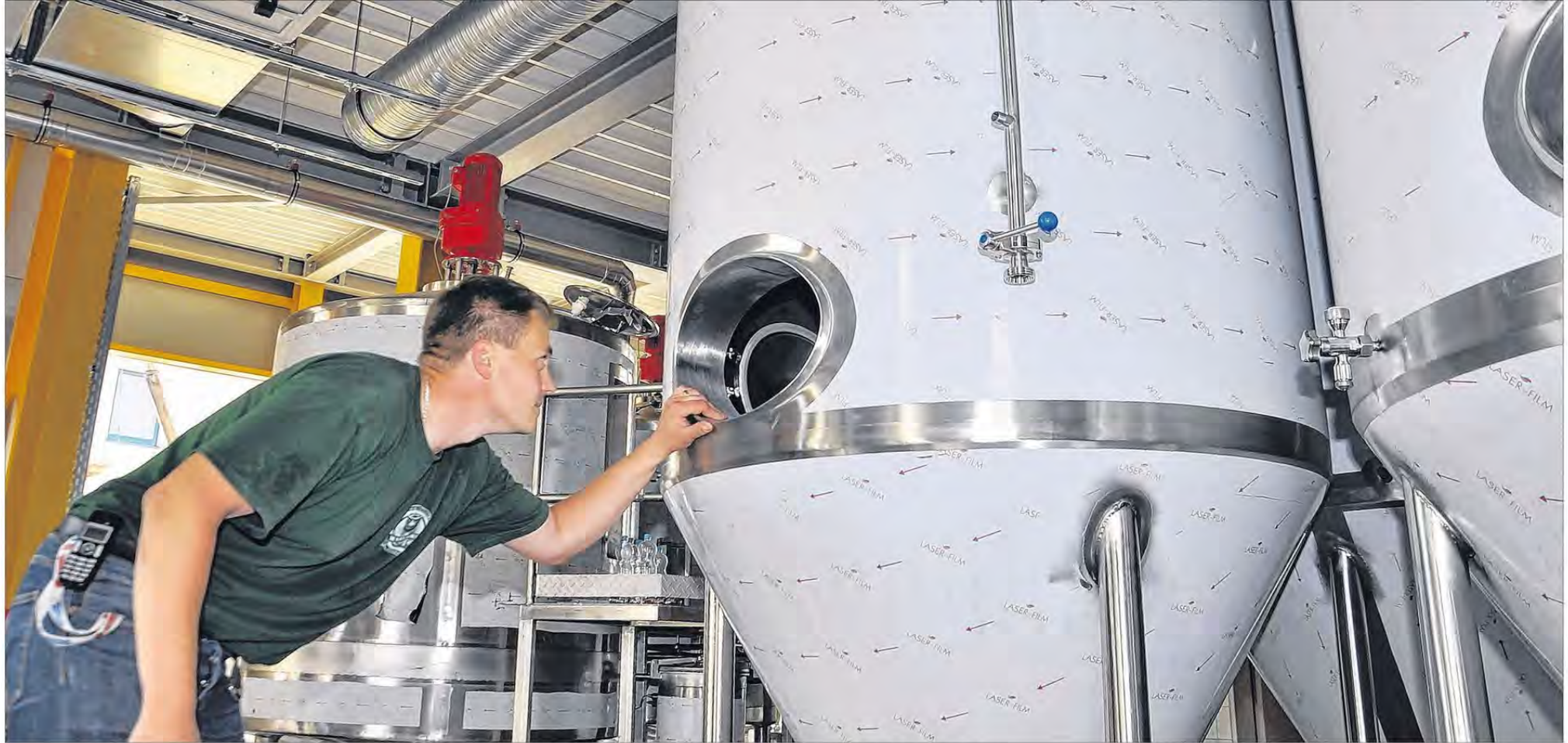
Brauer Daniel Engler kontrolliert die neuen Gär- und Lagertanks. Jeweils 2000 Liter Bier passen in die Edelstahlbehälter.
